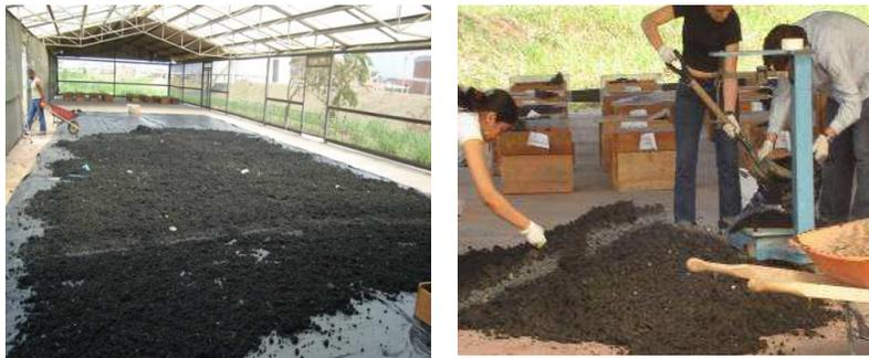
**Figura 1. Secado, empacado y pesaje del biosólido**
