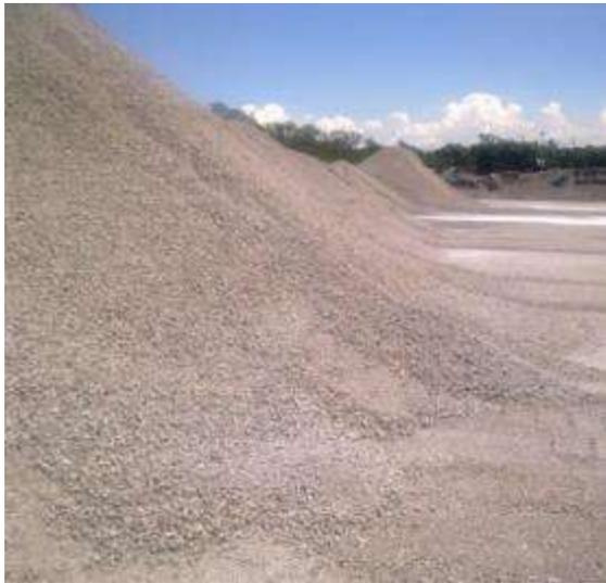
Uma vez gerado o REVSOL é depositado em local apropriado, de onde são coletadas amostras e enviadas ao laboratório para análise físico/química do coproduto, objetivando uma aplicação, técnica, economicamente viável e ambientalmente correta.
