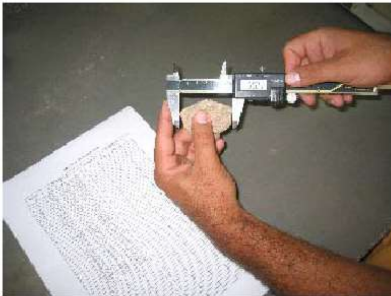
Figura 5.23: Leitura para determinação da forma do agregado reciclado estudado
