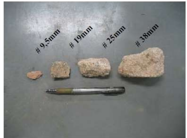
Figura 5.24: Frações granulométricas para determinação da forma do agregado reciclado estudado
