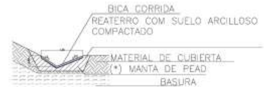
CANAL DE BERMA
