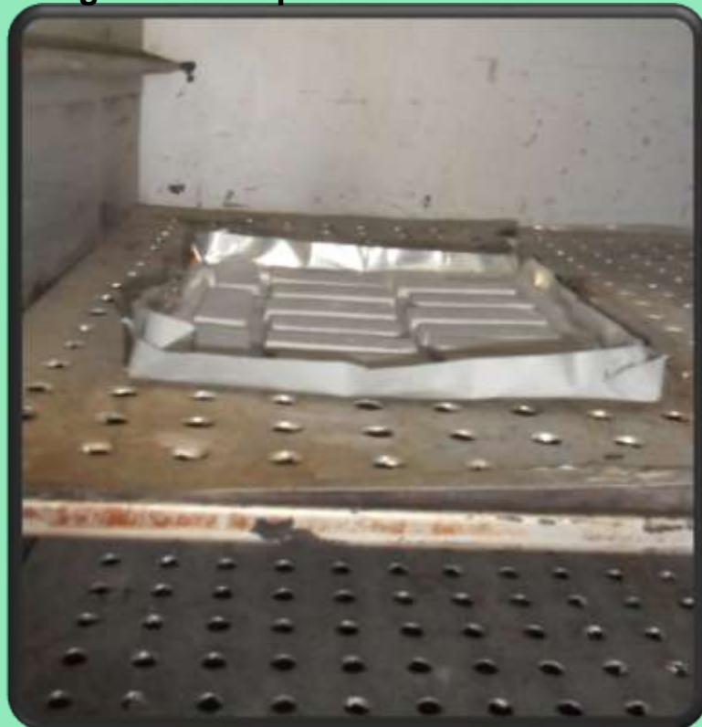
Figura 7 – Corpos cerâmicos na estufa
