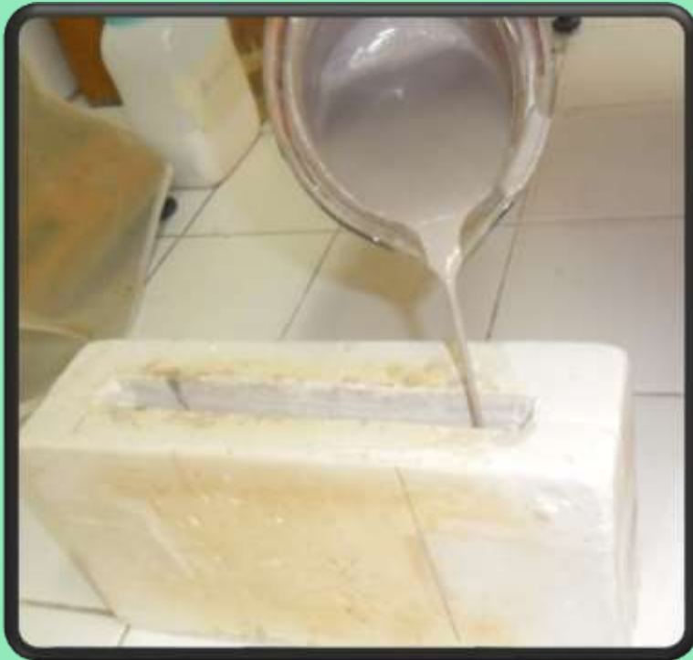
Figura 5 – Moldagem da barbotina cerâmica Figura 6 - Corpos cerâmicos moldados
