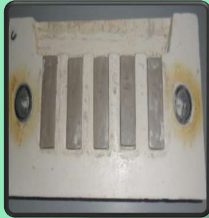
Figura 5 – Moldagem da barbotina cerâmica Figura 6 - Corpos cerâmicos moldados
