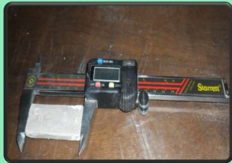
Figura 10 – Ilustrações da medição das peças e ruptura de flexão a três pontos
